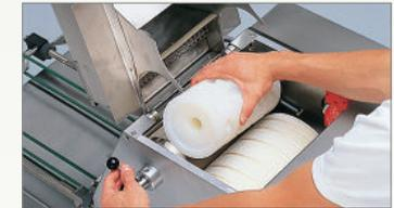
Durch herausnehmbare Komponenten leicht zu reinigen
