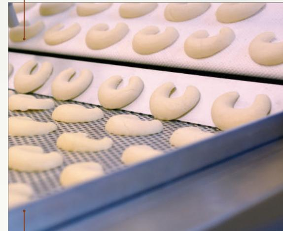
Bei der Belegung von Blechen mit höherem Rand mit Kleingebäck verhindert die Klapplippe ein Herunterpurzeln der Gebäcke. Die Gebäcke rutschen über die Klapplippe auf die Backbleche.
